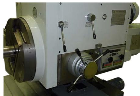
**Рычаги управления расточного станка**
